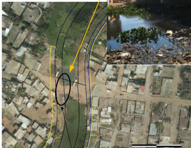
Approfondissement du chenal entre les 2 piles, jusqu'à la cote -3m NGH
